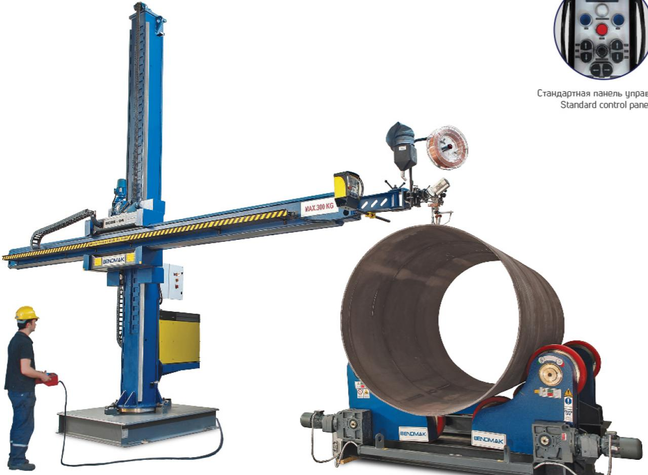
Сварочные колонны изготавливаются для обеспечения эргономики в процессе сварки, что позволяет достичь труднодоступных областей при сварке больших деталей и выполнять сварку с минимальными погрешностями. Сварочные колонны могут достигать наиболее подходящих мест заготовки для выполнения необходимых сварочных работ под контролем оператора или с помощью команд, посылаемых на автоматический блок сварочной колонны.
