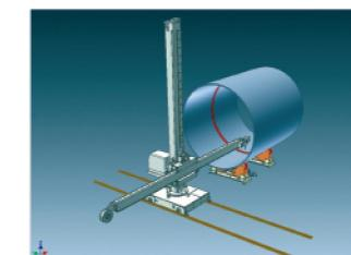
Сварка по внутреннему периметру (с вращающим устройством)
