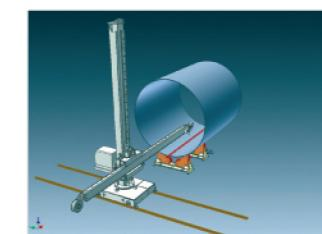
Внутренняя линейная сварка (посредством перемещения колонны)
